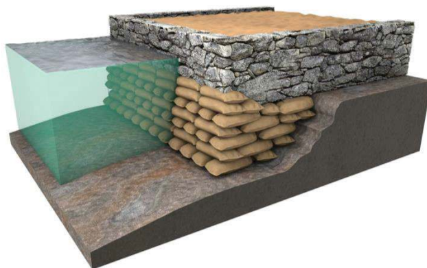
Εικόνα 1 - Τυπική υποθεμελίωση έργου βαρύτητας με σακκόλιθους σκυροδέματος
