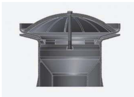
Εικόνα 1 - Ενδεικτικές διαμορφώσεις κυκλικών φρεατίων υδροσυλλογής καταστρώματος γεφυρών κατά ΕΛΟΤ EN 124-1
