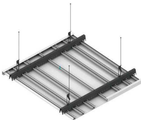
Σχήμα 2 - Στήριξη χαλύβδινων πλακών ή λωρίδων
