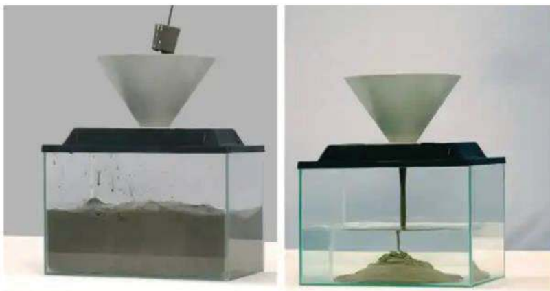
Εικόνα 1 - Δράση των προσθέτων μείωσης απόπλυσης του τσιμεντοπολτού
