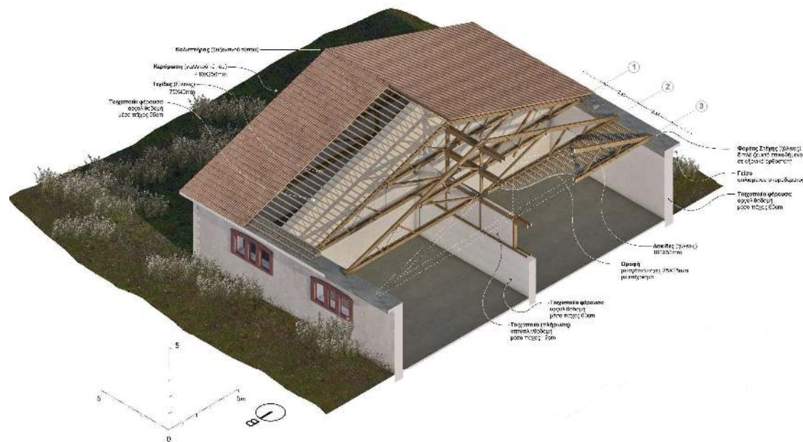
ΙΣΟΜΕΤΡΙΚΗ ΤΟΜΗ υφιστάμενη κατάσταση - κτίριο 8867
