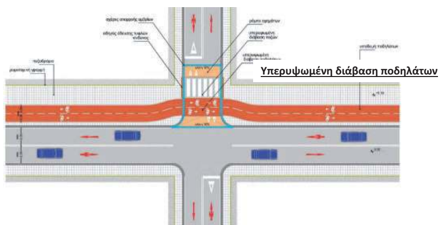
Εικόνα 1.3: Υπερυψωμένη διάβαση ποδηλάτων και πεζών
