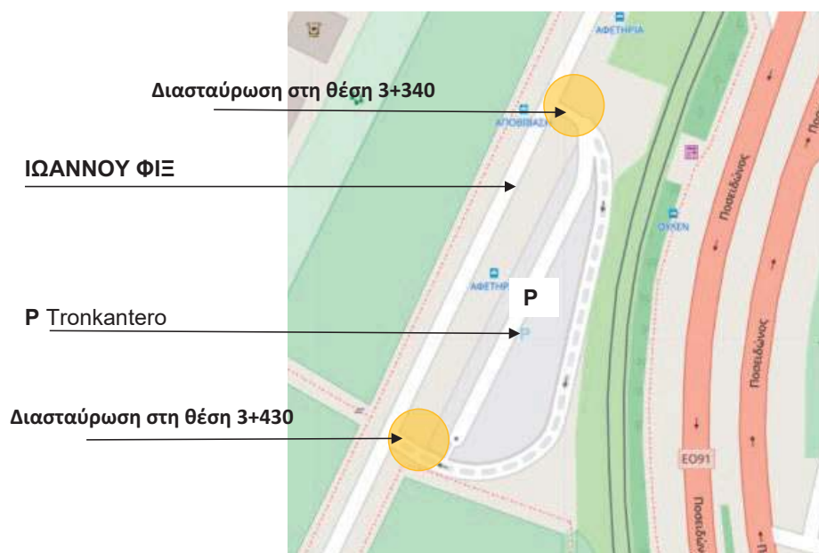
Εικόνα 2.10: Πρόταση διαμόρφωσης υπερυψωμένης διάβασης ποδηλάτων
